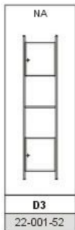
D3 Wymiary gabarytowe (szer. x głęb. x wys.): 464 x 400 x 1760 mm
