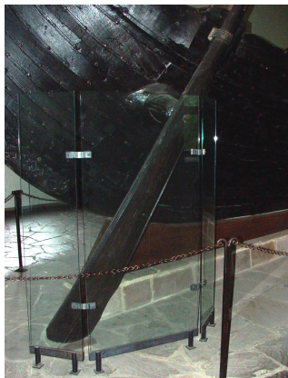
Ilustracja 2: Nef w przeciwieństwie do kogi posiadał ster burtowy.
