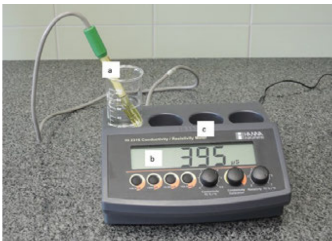
Fot. 4. Zestaw konduktometryczny: a – elektroda pomiarowa, b – wyświetlacz cyfrowy, c – zespół elementów pomiarowych w obudowie.
