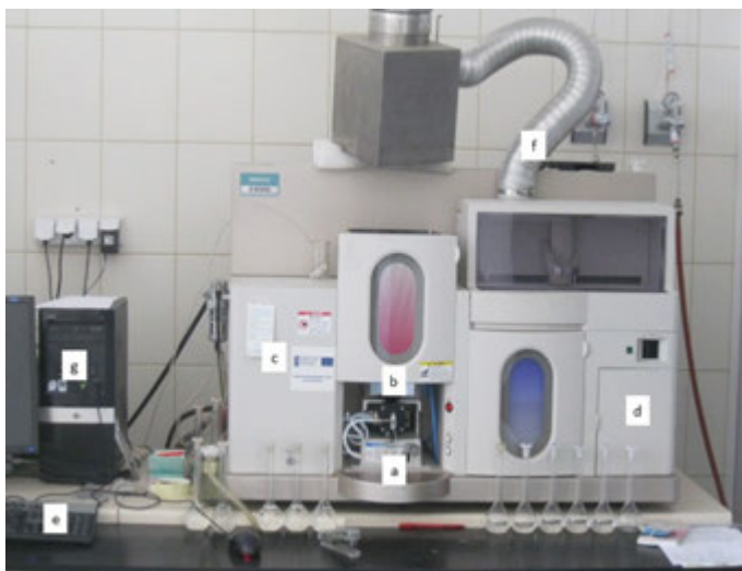
Fot. 1 Spektrofotometr Hitachi Z – 2000: a – kapilara zasysająca próbę, b – atomizer, c – układ optyczny, d – komora na lampy z katodą wewnętrzną, e – panel sterujący, f – ujściu spalin, g – jednostka komputerowa.
