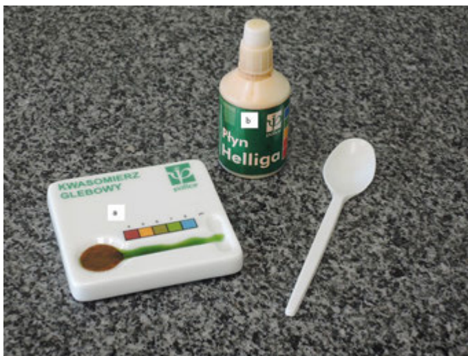
Fot. 2. Zestaw Helliga do oznaczania odczynu gleby: a – porcelanowa płytka z barwną skalą, b – zakraplacz płynu Helliga
