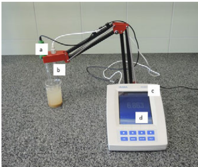
Fot. 3. Pehametr z elektrodą kombinowaną: a – elektroda kombinowana, b – czujnik temperatury, c – zespół elementów pomiarowych w obudowie, d – wyświetlacz cyfrowy
