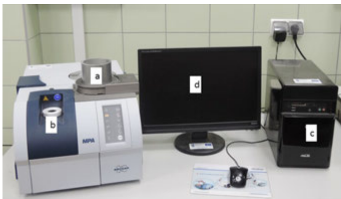
Fot. 7. Wielofunkcyjny analizator zawartości białka: a – kubek na próbę materiału sypkiego, b – komora na próby płynne, c – jednostka komputerowa, d – monitor
