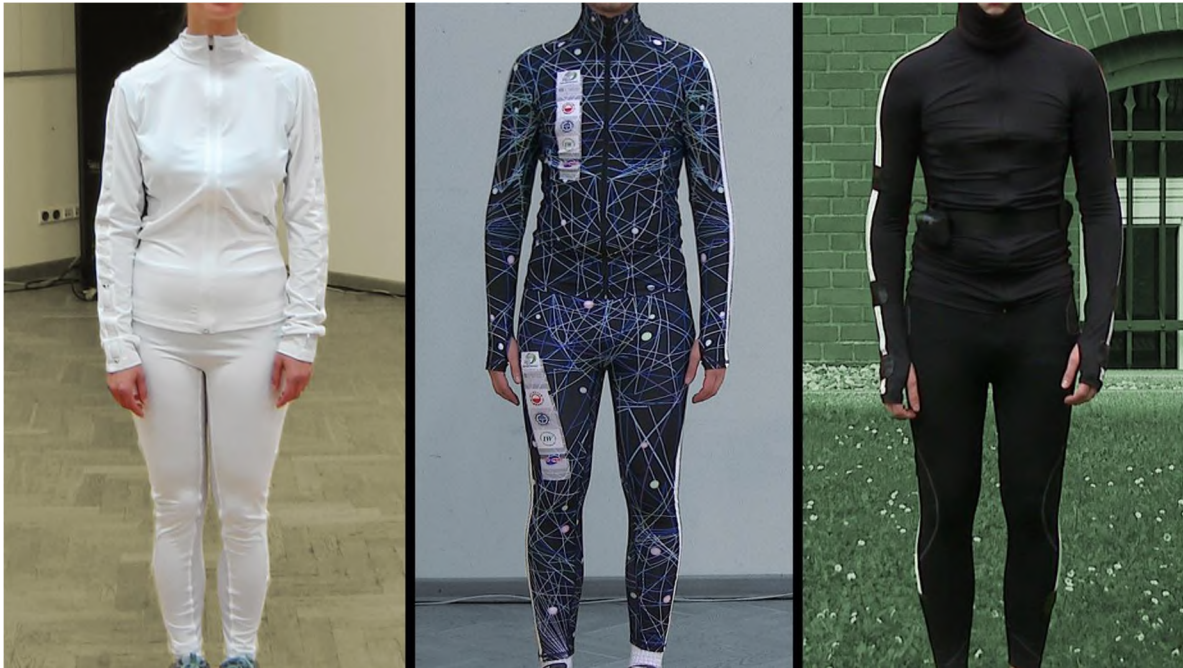
Rys.5. Trzy wersje kostiumu akwizycji ruchu z modułami i przewodami zintegrowanymi z odzieżą.
