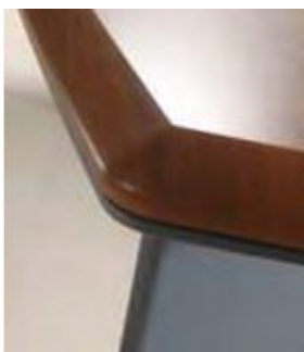
Rys.1 Frezowanie krawędzi blatu roboczego
